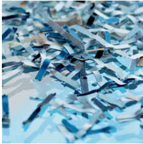
Sicherheitsstufe P-4: Empfohlen für Datenträger mit besonders sensiblen, vertraulichen und personenbezogenen Daten
